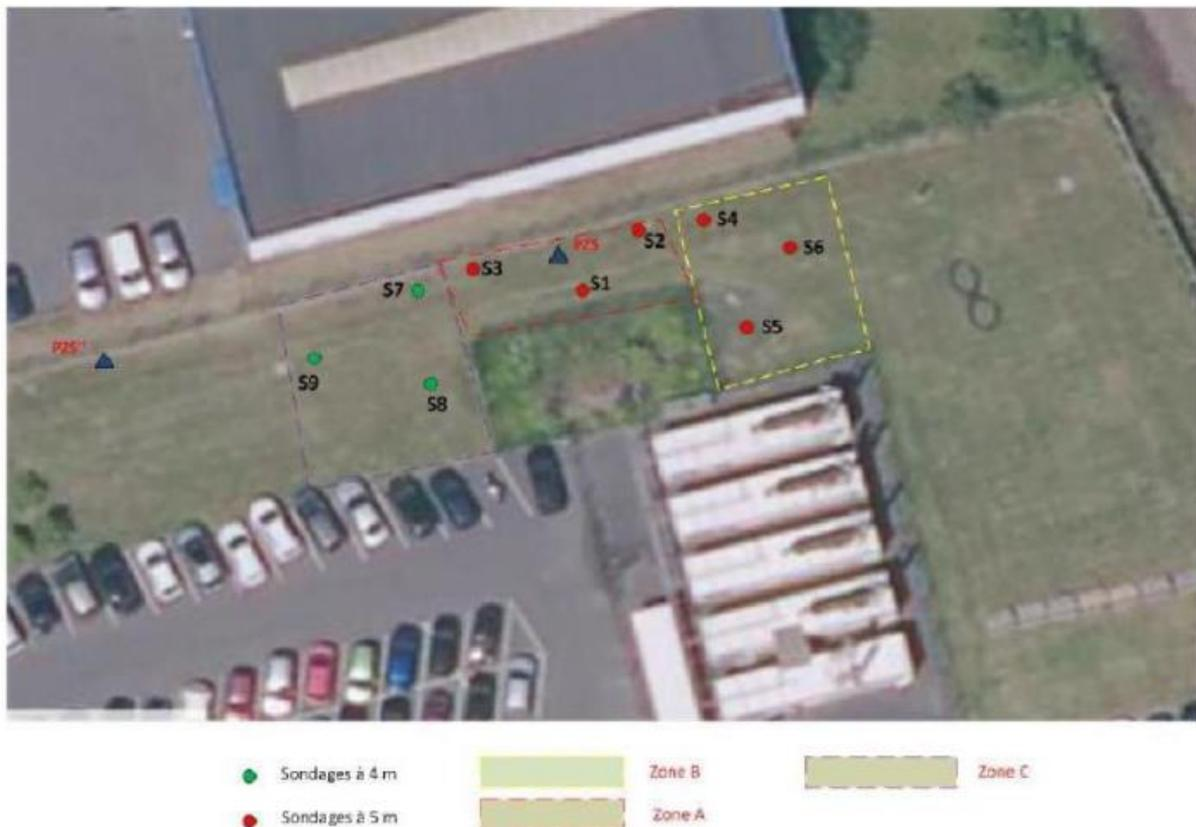
Figure 46 : Cartographie des points de sondage sur la zone Rbx 2
